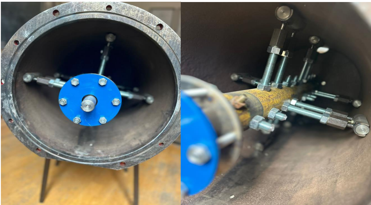
Şəkil3.1.2. Şokolad kütləsini kolloid üyütmə maşının daxili görünüşü
