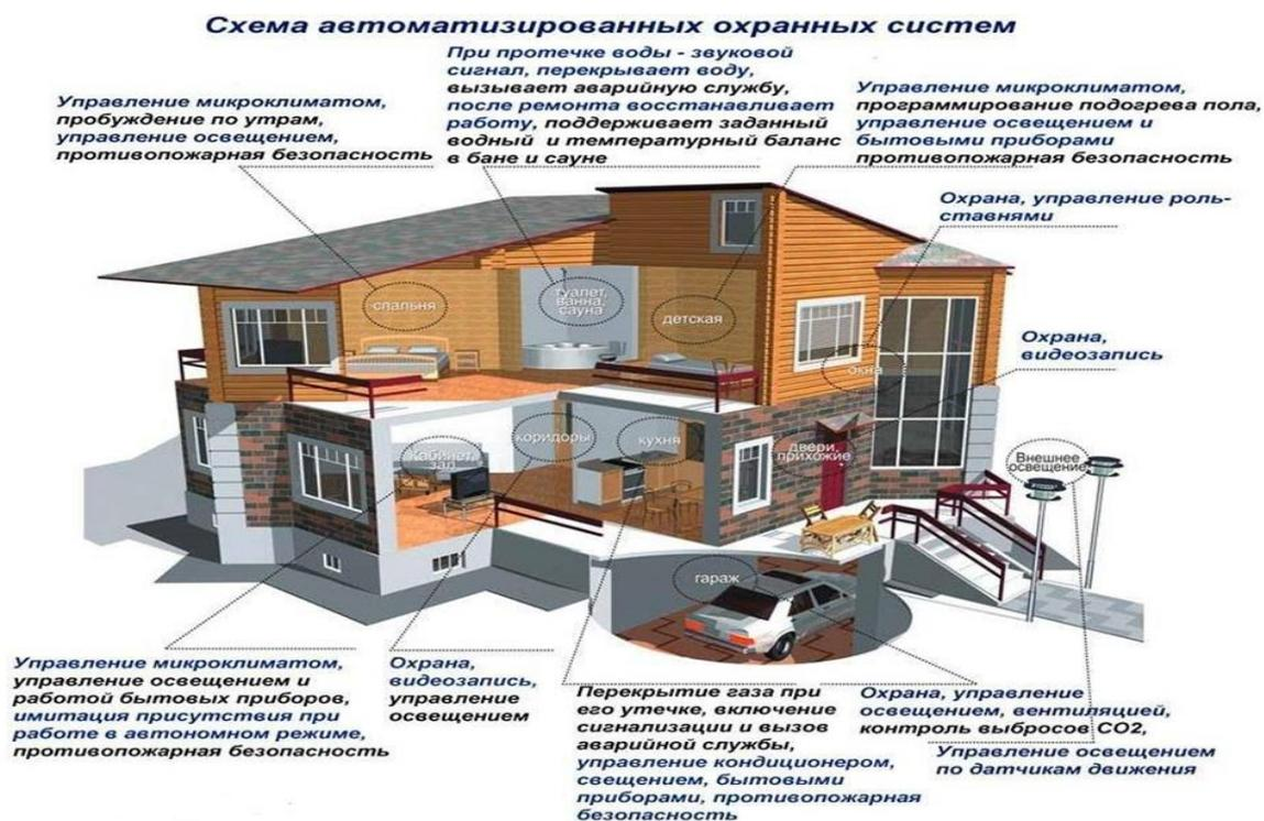
Рисунок 5. Схема автоматизированных охранных систем умного дома
