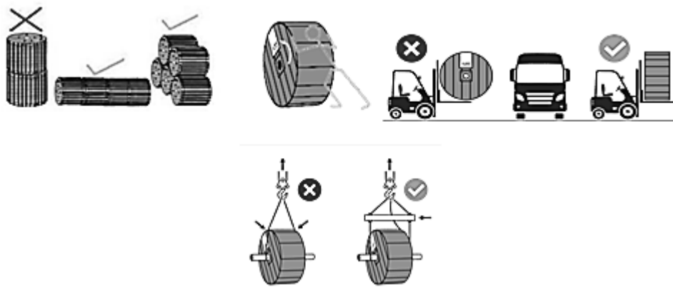
Şək 3.1.5. Barabanların nəqliyyat vasitəsinə yüklənməsi və ondan boşaldılması
