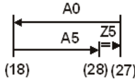
Şək. 4.2. Torna-yanyonuş əməliyyatında ölçü zəncirinin bəndləri
