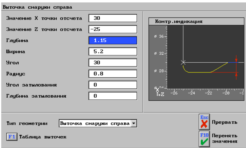
Şək. 6.10. M30x1.5 yivi üçün içyuvanın dərinliyinin avtomatik alınması üçün edilən düzəlişlər.
