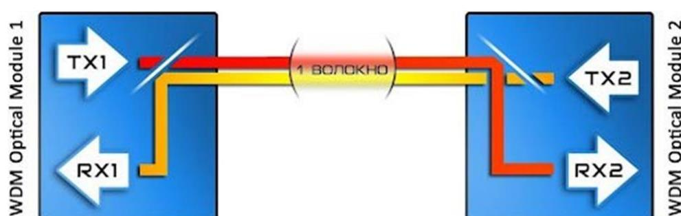
Рис. 1.3.1 – Схема, демонстрирующая простой принцип работы технологии WDM
