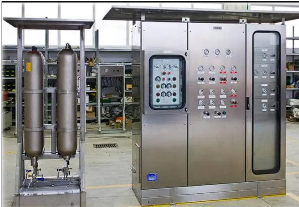
Şək. 1.2 Quyu ağzı idarəetmə paneli
