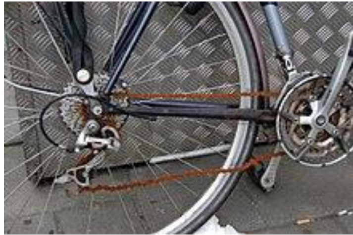
Şək.1.7. Velosiped zəncirinin korroziyası
