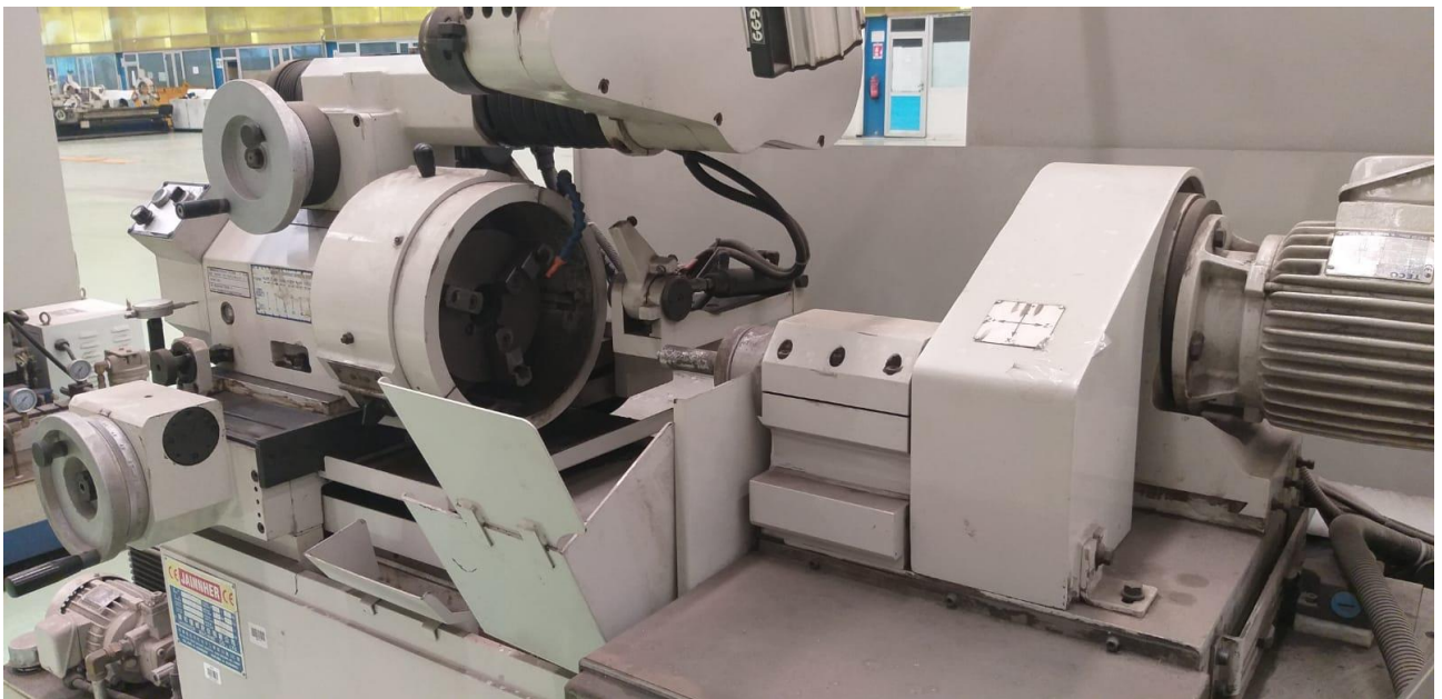
Şək.1.2. Neft maşınqayırmada istifadə edilən daxili pardaqlama qurğusu
