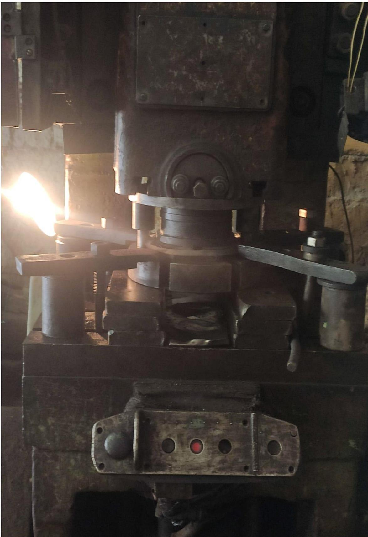
Рис.9 Вырубной станок в 8 атмосфер
