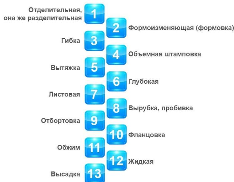
Рис.3 Различные виды штамповки
